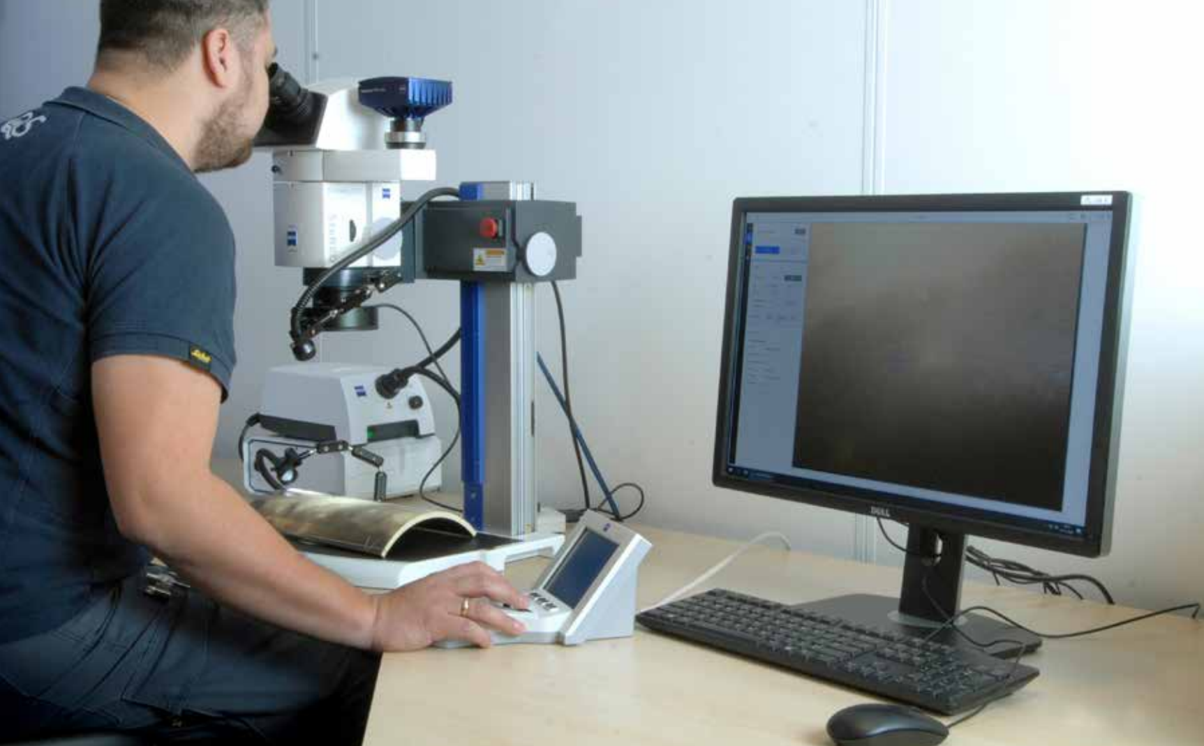
Microscopisch onderzoek t.b.v. aanwezigheid microscheuren.
